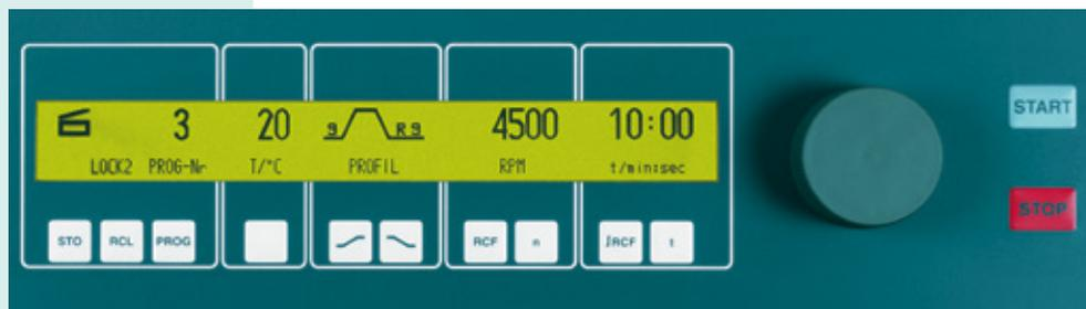
Panel de control de la ROTO SILENTA 630 RS: introducción de los parámetros mediante teclado laminar – precisa, rápida y sencilla con los botones de selección y el mando giratorio.
